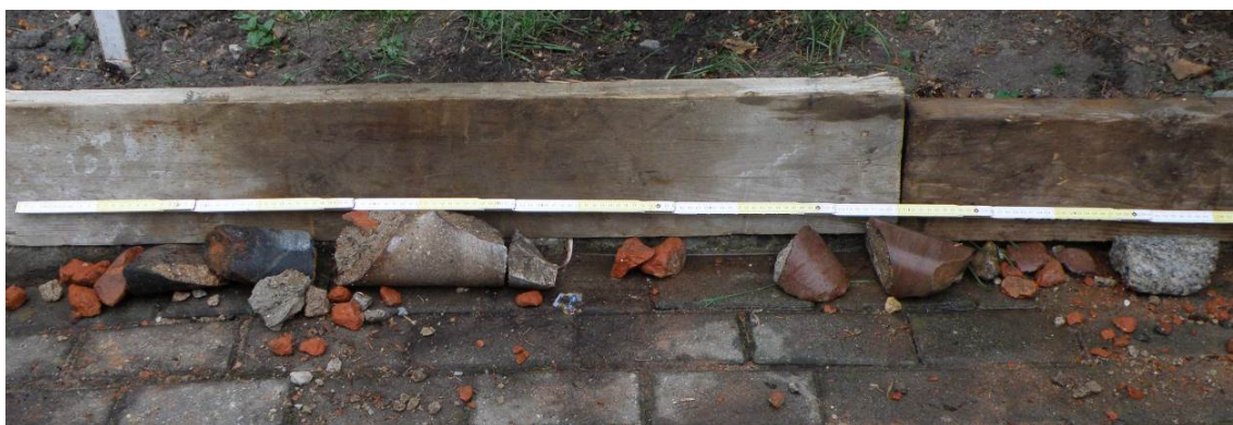
Fot. 9. Rdzeń d=100 mm z przewiertu ukośnego W-3 nachylonego 1:2 z poziomu terenu – rdzeń 1,50 m, głębokość posadowienia ściany południowej przy budynku >1,30 m p.p.t.
