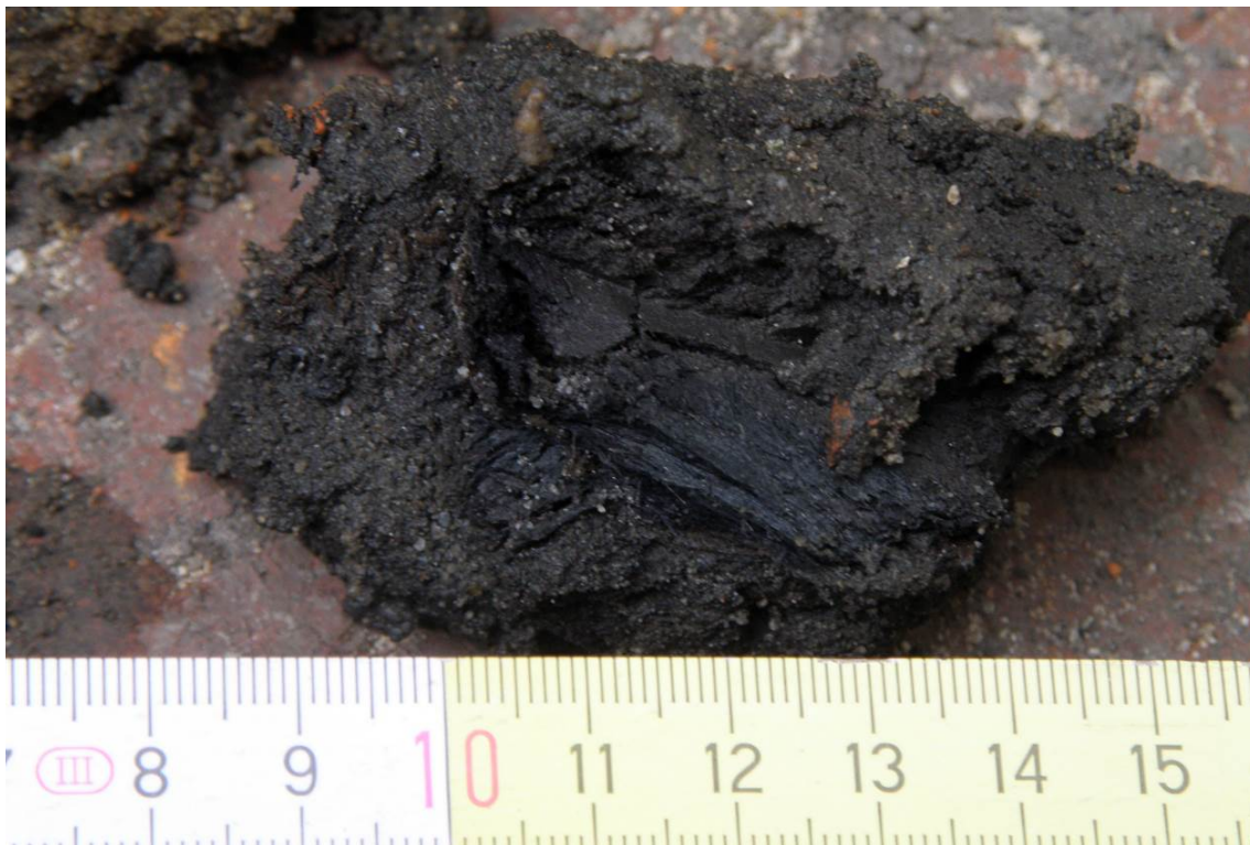
Fot. 4. Namuły piaszczyste z fragmentami drewna w otworze W-3
