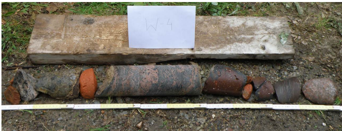
Fot. 10. Rdzeń d=100 mm z przewiertu ukośnego W-4 nachylonego 1:2 z poziomu terenu – rdzeń 1,00 m, głębokość posadowienia ściany zachodniej 0,85 m p.p.t.
