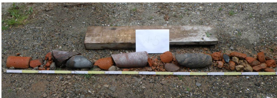
Fot. 11. Rdzeń d=100 mm z przewiertu poziomego W-5 na wysokości 1,5 m p.p.t – grubość ściany zachodniej 1,60 m
