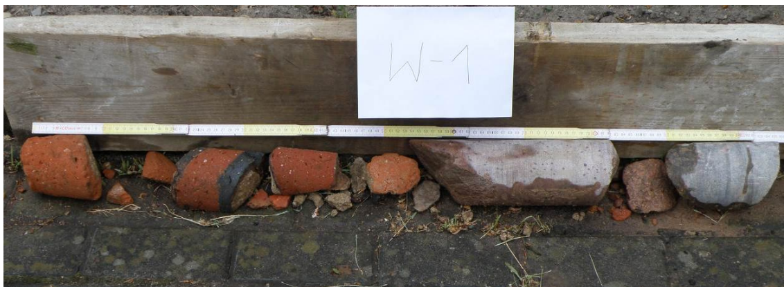
Fot. 7. Rdzeń d=100 mm z przewiertu ukośnego W-1 nachylonego 1:2 z poziomu terenu – rdzeń 1,05 m, głębokość posadowienia narożnika południowo zachodniego 0,90 m p.p.t.
