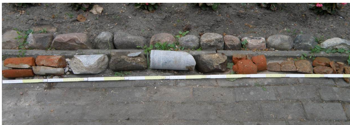
Fot. 12. Rdzeń d=100 mm z przewiertu poziomego W-6 na wysokości 1,5 m p.p.t. – grubość ściany południowej 1,80 m
