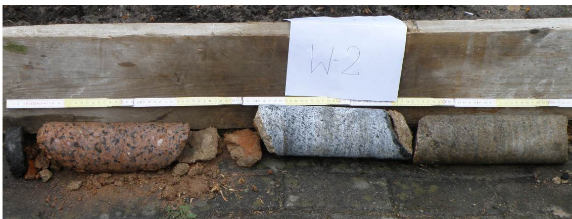
Fot. 8. Rdzeń d=100 mm z przewiertu ukośnego W-2 nachylonego 1:2 z poziomu terenu – rdzeń 1,05 m, głębokość posadowienia ściany południowej >0,90 m p.p.t.
