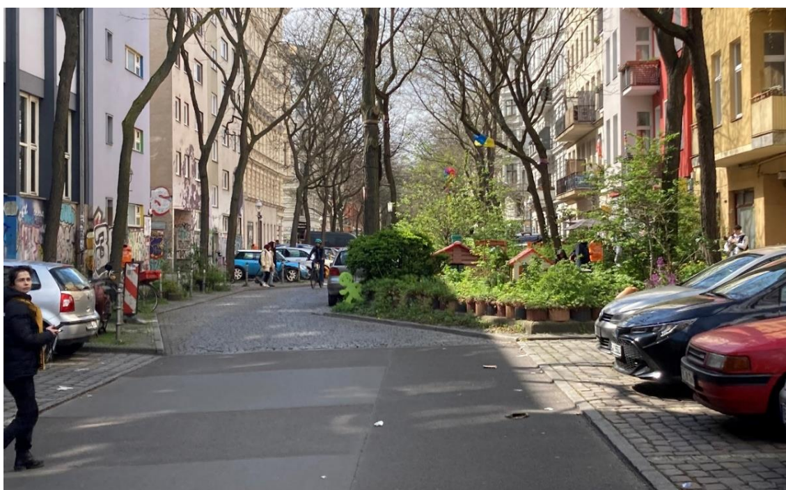
Zdjęcie 8. Berlin, Böckhstraße – zwężenie jezdni (szykana) wykorzystane do budowy skweru
