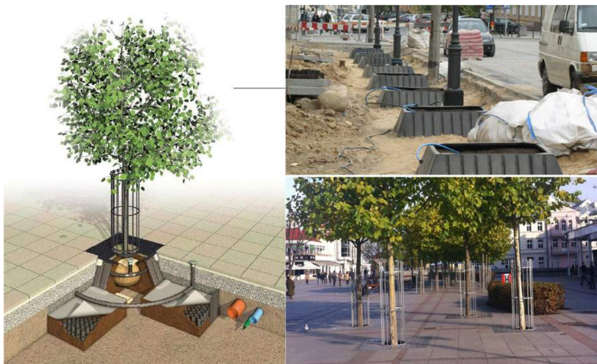
Właściwie technologicznie nasadzenie drzew przyulicznych (rozwiązanie techniczne wybrane przykładowo)
