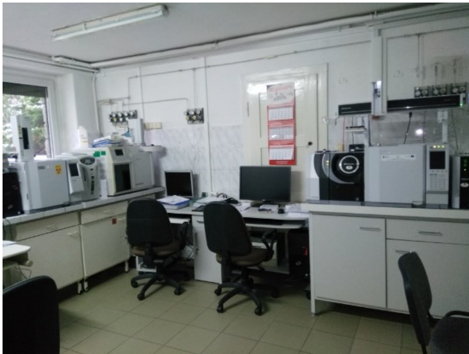
Fot. Pokój chromatografii w przyziemiu: znajdują się tu obecnie 4 chromatografy i analizator OWO – wszystkie urządzenia stale wykorzystywane, niektóre pracują również w nocy.
